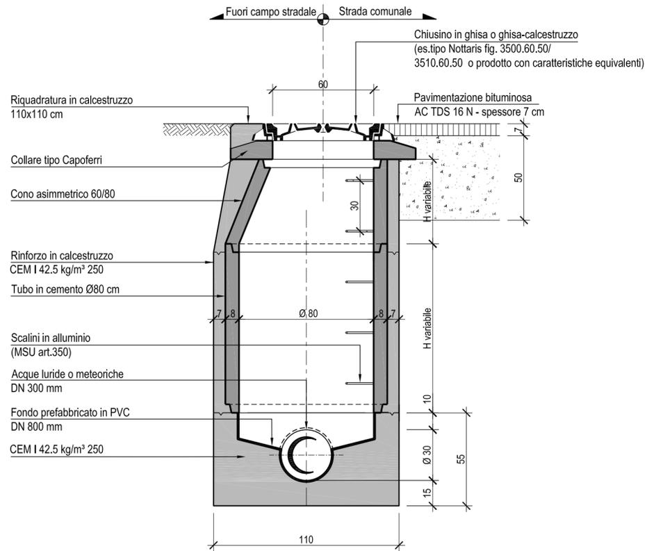
**Pianta pozzetto tipo sistema separato
