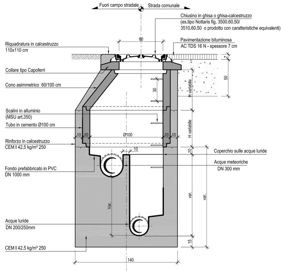
**Sezione pozzetto tipo sistema unitario
