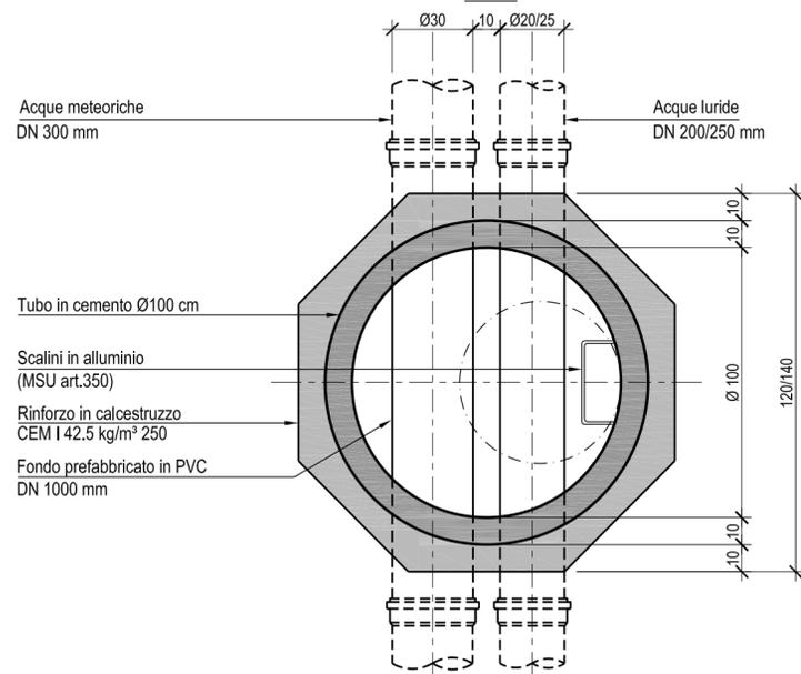
**Pianta pozzetto tipo sistema unitario
