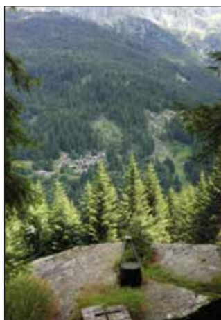
A sinistra: Punto di controllo in zona Bova per il monitoraggio geodetico.
