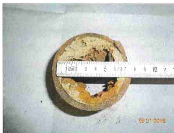
Fotografie estratte dal PGA, quale esempio dello stato dei tubi in acciaio di Biasca.
