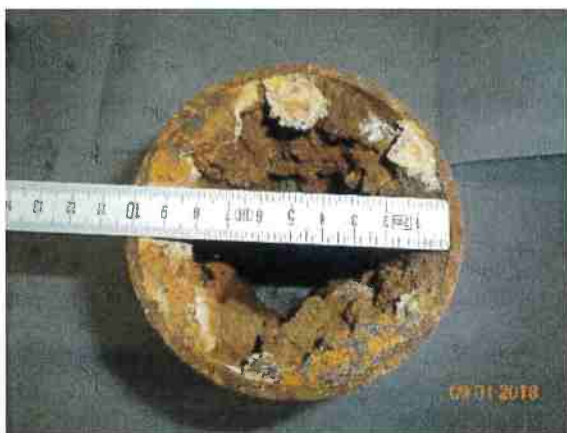
Fotografie estratte dal PGA, quale esempio dello stato dei tubi in acciaio di Biasca.
